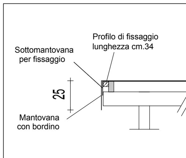
Sezione tipo fissaggio telo
